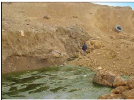
شکل ۲- زهاب دامپ ۱۱ در دوره پر آبی (pH≈۳/۵)، تراکم بالای جلبک‌ها مشهود است
