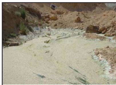
شکل ۳- زهاب دامپ ۱۱ در دوره کم آبی (pH≈۴/۵)، رسوب سولفات‌های مس و آهن
