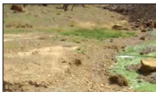
شکل ۷- زهاب‌های دامپ ۲۶ در بهار، کاهش تراکم جلبک‌ها در زهاب اصلی با کلوییدی شدن زهاب و انحلال سولفات‌ها در زهاب فرعی و جایگزینی با جلبک‌های سبز
